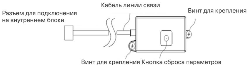
Модуль GC-LCF/CLO (GC-LCF/CLO2) может работать со смартфоном, беспроводным маршрутизатором, который может реализовывать мониторинг на расстоянии, ежедневное управление, настройку температуры и связанные функции.
